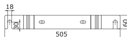
Obr. 7 Upevňovací konzola pro závěsné nádoby
